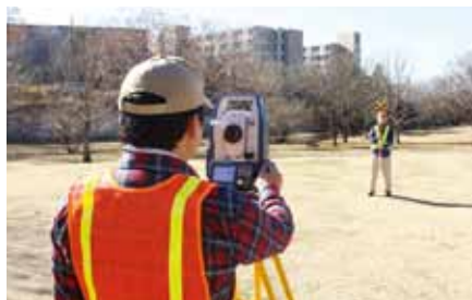
간편한 좌표측정 “대략 시준”과 트리거 키를 이용하여 정확하게 프리즘을 측정할 수 있습니다.
